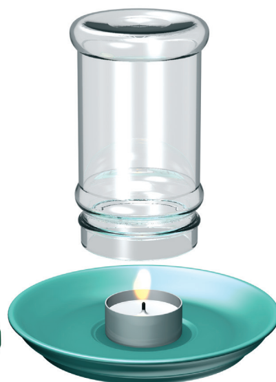
Spaľovacie plyny z čajovej sviečky sú zachytené.
